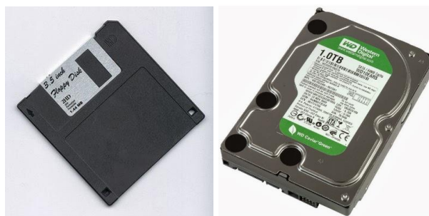
ภาพที่ 3.12 อุปกรณ์บันทึกข้อมูลในลักษณะแถบแม่เหล็ก แผ่นฟลอปปีดิสก์ ฮาร์ดดิสก์
