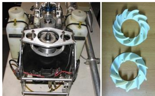
ภาพที่ 5.15 แสดงออกแบบรูปทรงของพัดลมระบายความร้อนใหม่ให้มีความเหมาะสม ซึ่งในกระบวนการออกแบบพัดลมระบายความร้อนนี้ได้ใช้เครื่อง 3D Printer มาช่วยในกระบวนการออกแบบ
